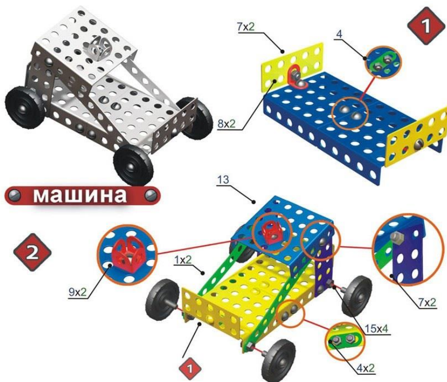
Рис. 1 Берем две площадки соединяем их между собой плоской скобой с помощью маленьких болтов и гаек. К боковинам крепим пластины (7x2) с помощью скоб на болт и гайку (на внутреннюю сторону) с обеих сторон
